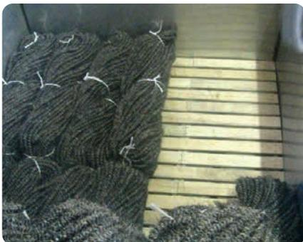
Die Kräuselung wird nach althergebrachter Tradition schonend mit Wasserdampf für immer fixiert. 3 Stunden bei höchster Dampftemperatur werden die Haare gedämpft. Dabei wird das Haar einer Markveränderung unterzogen und die enge Kräuselung für immer fixiert.
