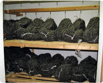
Bis zu 3 Tage dauert die Trocknung der Rosshaar-zöpfe, mit viel warmer Luft, in der Trockenkammer. Hier wird das Rosshaar langsam an eine normale Luftfeuchtigkeit gewöhnt. Um bei diesem Vorgang eine Dampfdiffusion zu vermeiden, wird die Haar-temperatur schrittweise an die Raumtemperatur angepasst.
