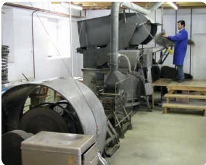
In der eigenen Rosshaarspinnerei werden die Haare zuerst mit der Hechelmaschine gekämmt, die die Haare von Verknotungen befreit. Im Anschluss dreht moosburger® die Schweifhaare auf der Spinnmaschine zu sehr dünnen Zöpfen. Je dünner die Zöpfe gedreht sind, desto mehr Windungen bekommt das Haar und desto stärker ist die Sprungkraft nach dem Aufdrehen.
